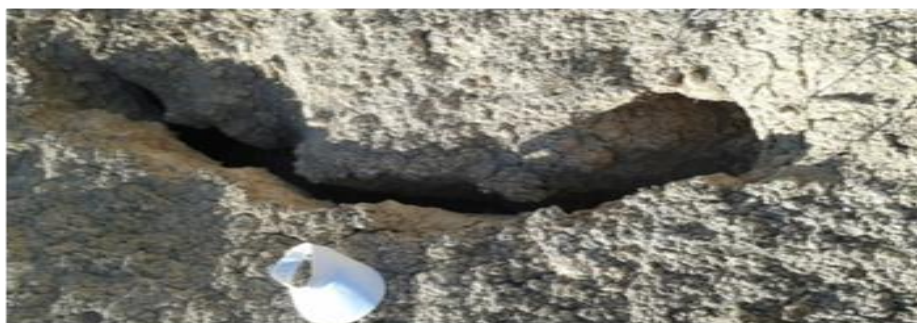
شکل ۸: درز و شکاف‌های ایجاد شده در اثر انحلال دیابیر نمکی (منبع: نگارنده ۱۳۹۶)
