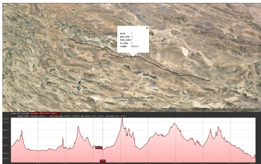
شکل ۷. تصویر سه بعدی منطقه و مسیر مبتنی بر شیب
